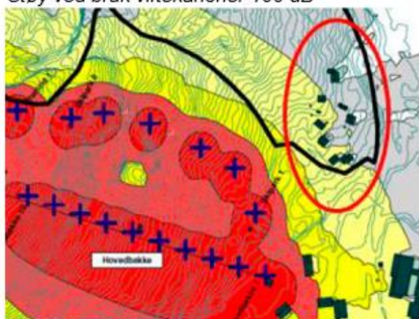
Støy ved bruk viftekanoner 100 dB
